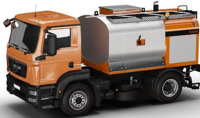
Los distribuidores de emulsión Strassmayr Silver están creados para regar de manera uniforme y eficaz. Equipado con tanque elíptico especial cubierto por aluminio, control de riego computarizado automático, asegura la máxima calidad a un precio razonable. El control por computadora asegura el mantenimiento de una presión constante de la emulsión incluso cambiando la velocidad o el ancho de riego.
